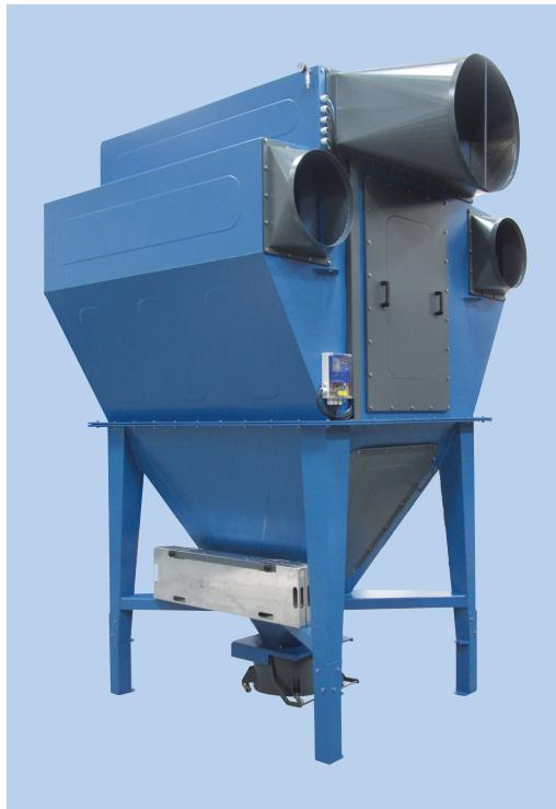
Energioptimeret anlæg til større filtreringsopgaver. Anvendes til filtrering af svejserøg, slibestøv, skærerøg og støvfuldt luft indeholdende metal, sten, plast osv. eller fra håndtering af diverse pulvermix.
